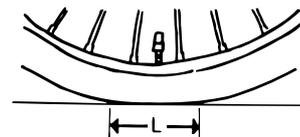
接地面の長さ(L) : 90~110mm
