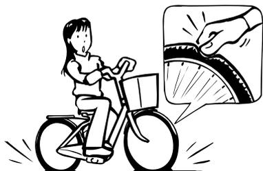
タイヤの空気圧が低下している
