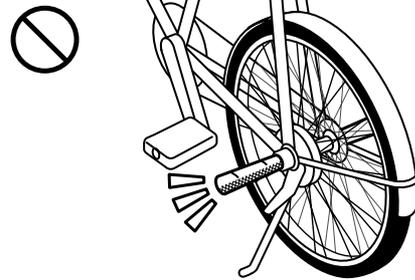
後ハブ軸にハブステップを取付け、2人乗りで使用すると、ハブステップが破損して転倒したり、事故を起こす危険があります。
