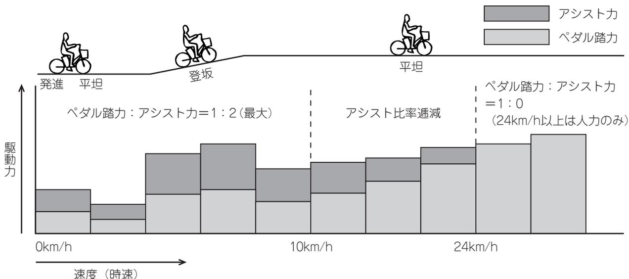
アシスタのアシストシステムは、ペダルを踏む力に補助的な力を加えて走行を助けてくれるシステムです。
