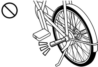
後ハブ軸にハブステップを取付け、2人乗りで使用すると、ハブステップが破損して転倒したり、事故を起こす危険があります。
