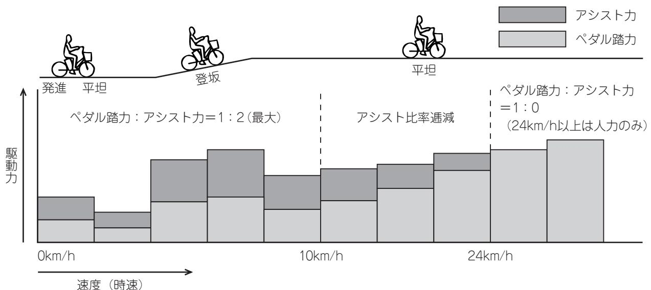
bikke<sup>2</sup> e のアシストシステムは、ペダルを踏む力に補助的な力を加えて走行を助けてくれるシステムです。
