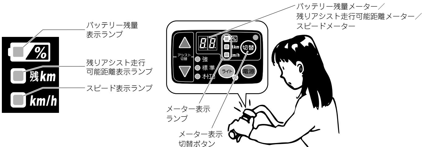
メインスイッチメーターに表示されるデジタル数値は、バッテリー残量と残リアリスト走行可能距離の目安を表示します。また、スピードメーターは走行速度（時速）を表示します。
