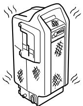
バッテリー底部の接点を短絡（ショート）させない
