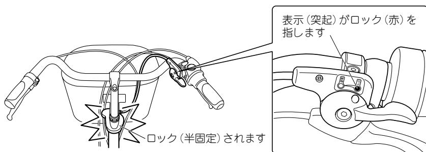
\*1 誤動作防止のため、初めに解除レバーを引き上げないと、ロックレバーが下へ動かせない安全機構になっています。
