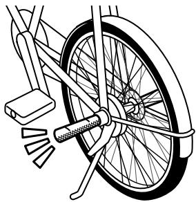
後ハブ軸にハブステップを取り付け、2人乗りで使用すると、ハブステップが破損して転倒したり、事故を起こす危険があります。
