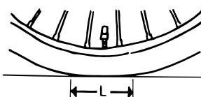
接地面の長さ(L) : 100~120mm
