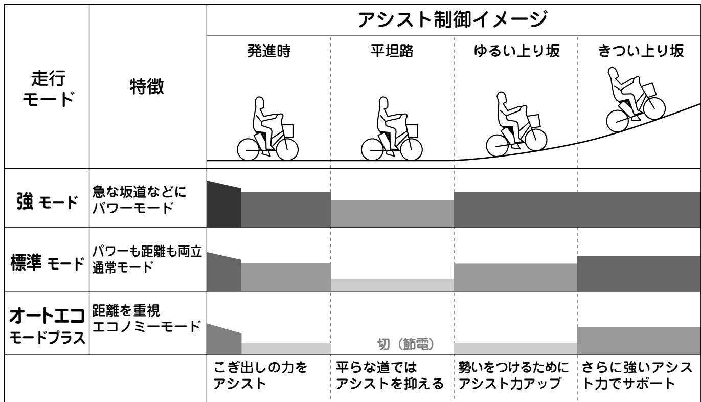
※イラストはイメージであり、実際の走行条件（路面条件・風など）によって変化します。
