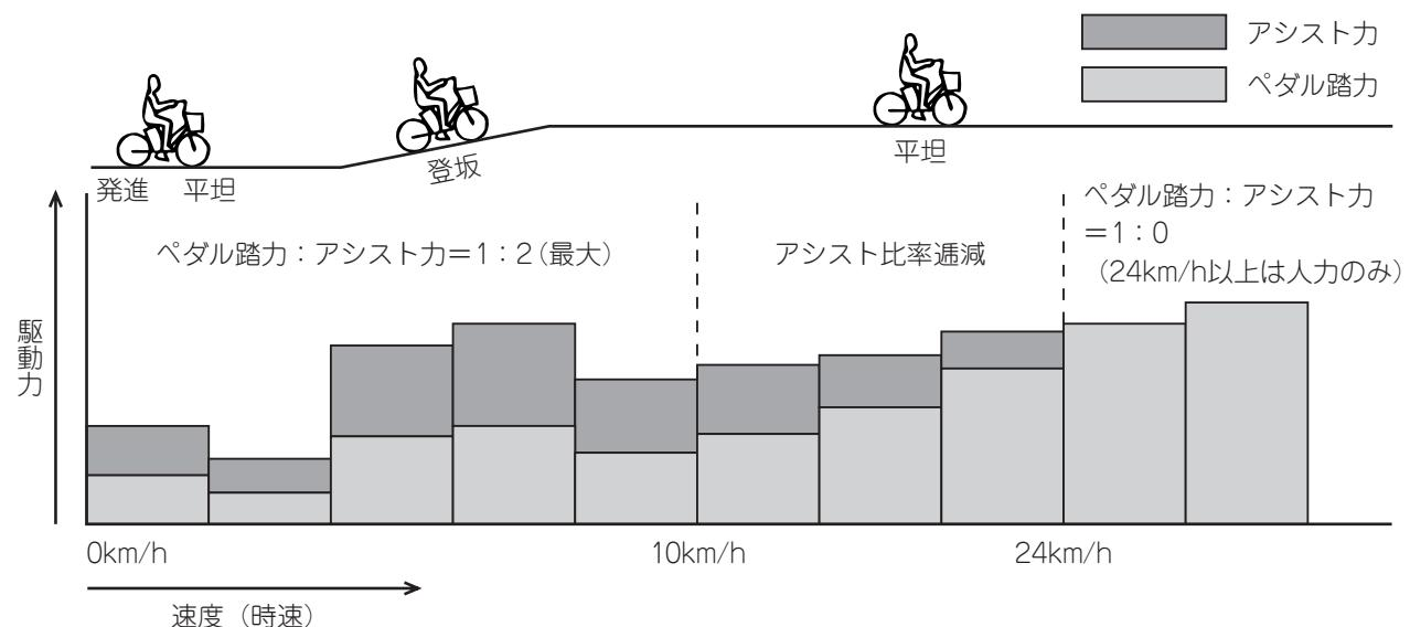
bikke MOB e のアシストシステムは、ペダルを踏む力に補助的な力を加えて走行を助けてくれるシステムです。
