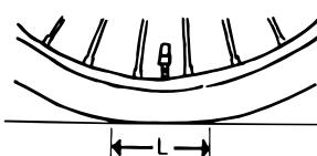
接地面の長さ(L) : 100～120mm
