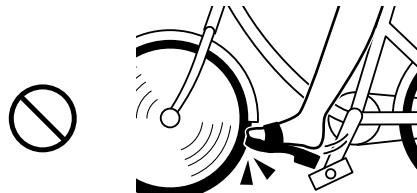
足がペダルから外れて、靴(サンダルなど)が前輪に接触するとハンドル操作ができなくなったり、前輪に靴(サンダルなど)が巻き込まれて転倒するおそれがあります。
