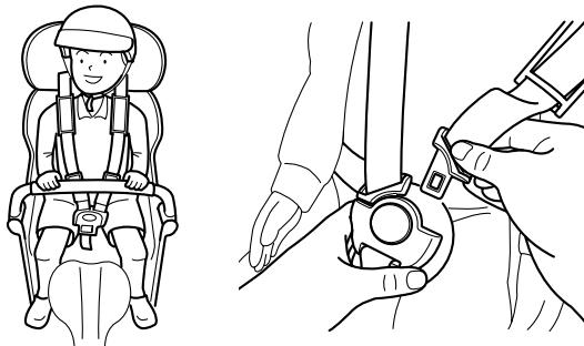
お子様がチャイルドシートに着座したとき、ヘッドガード上端が頭部の中心より高くなるように調整してください。
