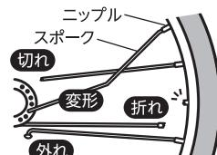
ホイールが変形し、ブレーキと接触して走行性が損なわれ、転倒するおそれがあります。スポークが一本でも外れたまま走行を続けると、他のスポークに大きな負担が繰り返し加わり、スポーク寿命が低下し、スポーク切れが継続して発生する場合があります。スポークは全て交換することをお勧めします。
