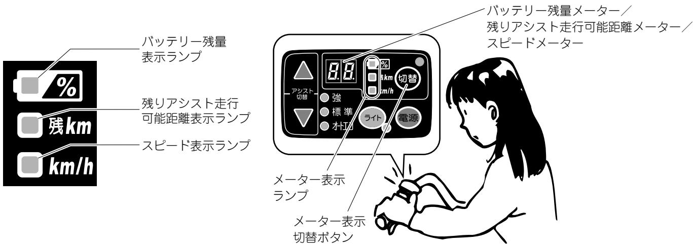
メインスイッチメーターに表示されるデジタル数値は、バッテリー残量と残リアシスト走行可能距離の目安を表示します。また、スピードメーターは走行速度（時速）を表示します。
