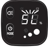
“SL” が3秒間早点滅(0.2秒間隔)                                                                      | <b>スリップ制御機能作動表示</b><br>⇒スリップ制御機能が作動したときに表示します。スリップ制御機能についてはP75をご参照ください。                                        |
