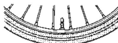
接地面の長さ(L) : 100～120mm (測定時の参考条件 : 乗員体重60kg)
