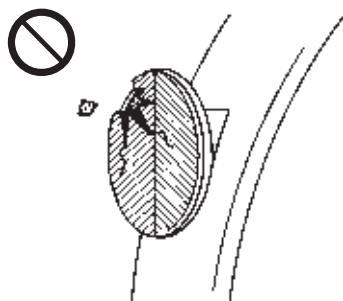
⚠ 変形したり破損した部品はすぐに交換すること
