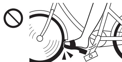
足がペダルから外れて、靴(サンダルなど)が前輪に接触するとハンドル操作ができなくなったり、前輪に靴(サンダルなど)が巻き込まれて転倒するおそれがあります。
