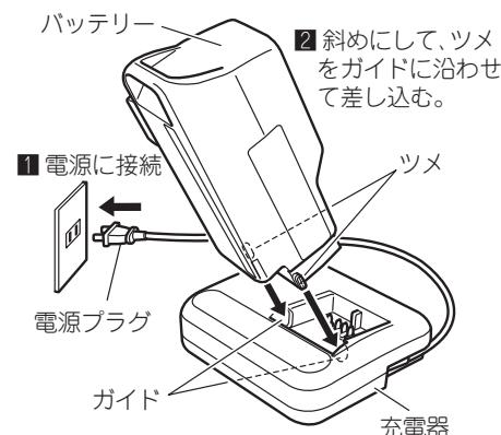
**3** バッテリーを充電器に対してまっすぐに起こし確実に充電器へ接続します。(図のAの方向へ押すようにします)
