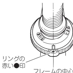
3 解除後、リングの赤い●印がフレーム(車体)の中心と合っている状態で、ハンドルがスムーズに回ることを確認します。
