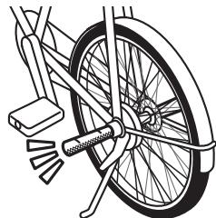
後ハブ軸にハブステップを取り付け、2人乗りで使用すると、ハブステップが破損して転倒したり、事故を起こす危険があります。
