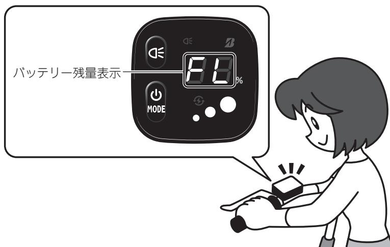
バッテリーのバッテリー残量ランプを確認するときは、バッテリー残量ランプの上側のバッテリー残量表示ボタンを押します。
